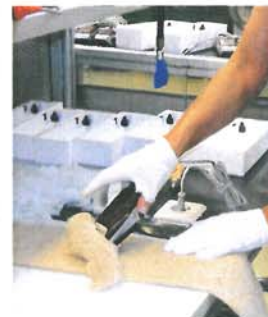
Jede Haarschneidemaschine durchläuft am Ende des Produktionsprozesses einen anspruchsvollen Schneidtest.
